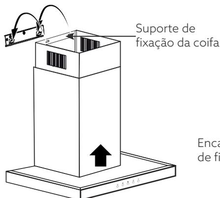
Encaixe a coifa nos ganchos do suporte de fixação instalado na parede.
