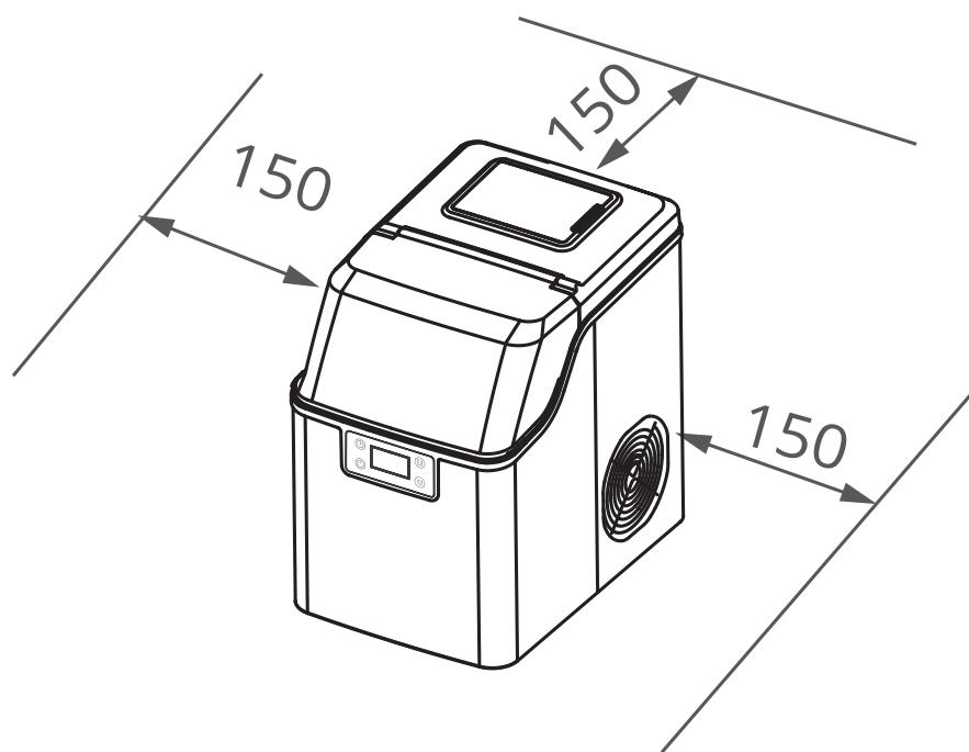
A superfície de instalação deve ser plana. Não posicione em superfícies inclinadas. Mantenha uma distância de pelo menos 150 mm entre a parte traseira e a parede e nas laterais de no mínimo de 150 mm livre do ice maker.
