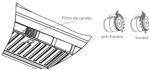
**NOTA:** Certifique-se de que o filtro está firmemente travado para evitar o risco de acidente, com a sua queda. Quando o filtro de carvão ativado estiver instalado, a potência de sucção será reduzida.
